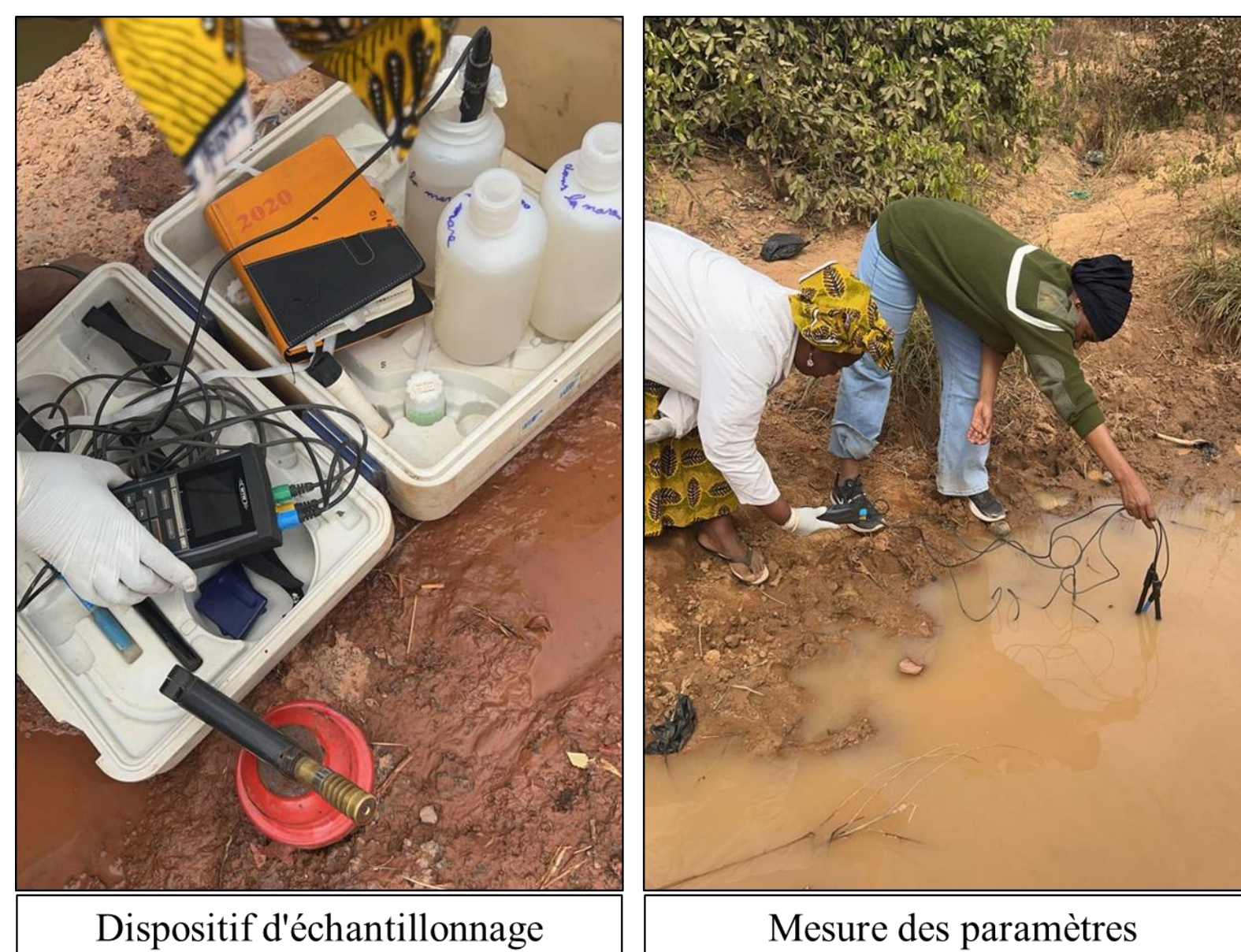
Fig. 2: Campagne d'échantillonnage d'eau de la mare et des 2 piézomètres avoisinant
