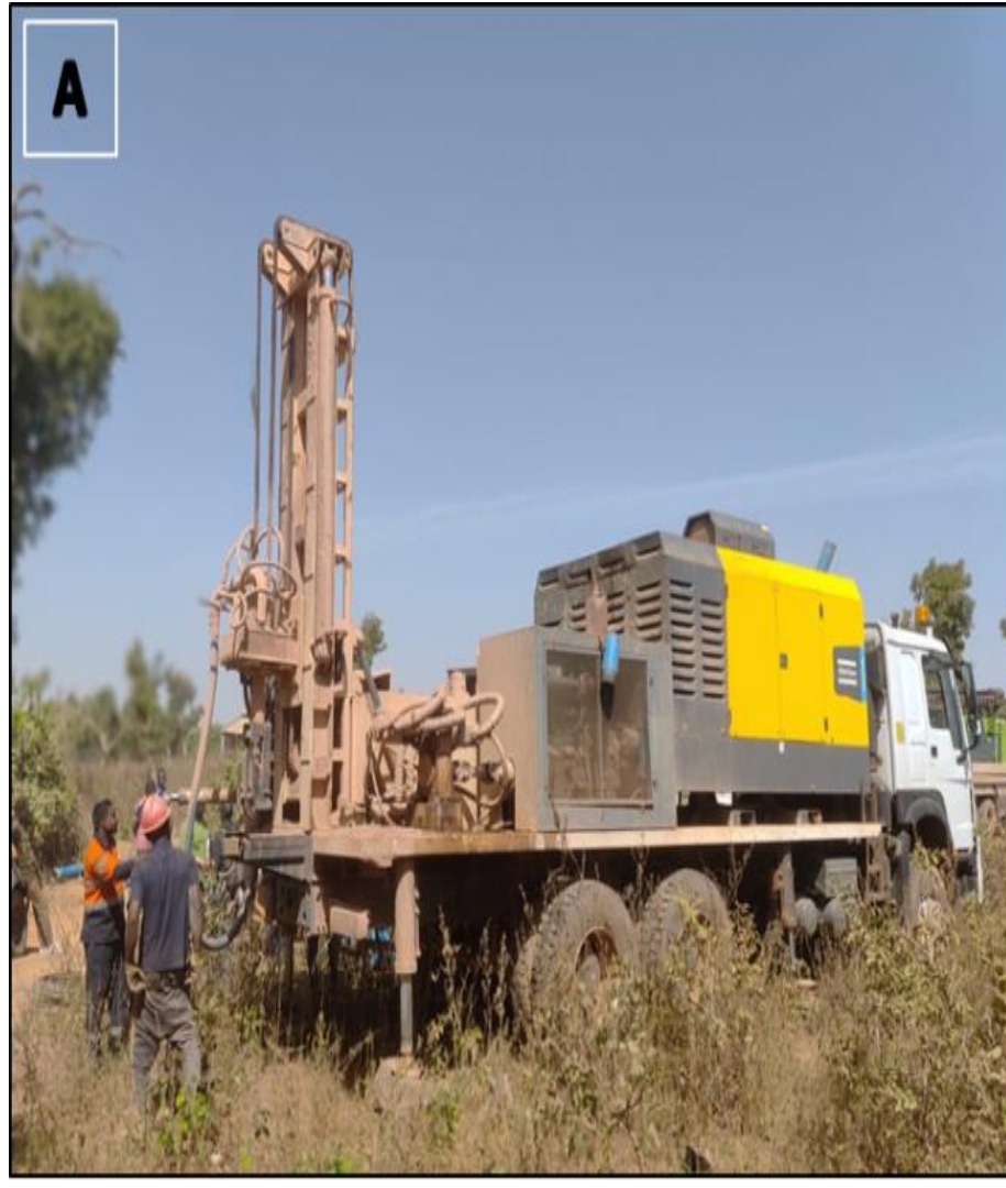
Fig. 3: Foreuse, Sondeuse avec système rotatif, Marteau fond de trou et Accessoires pour la réalisation des piézomètres
