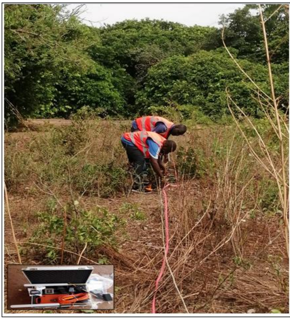
Fig. 2: Résistivimètre PQWT TC150 & Identification des points de captage
